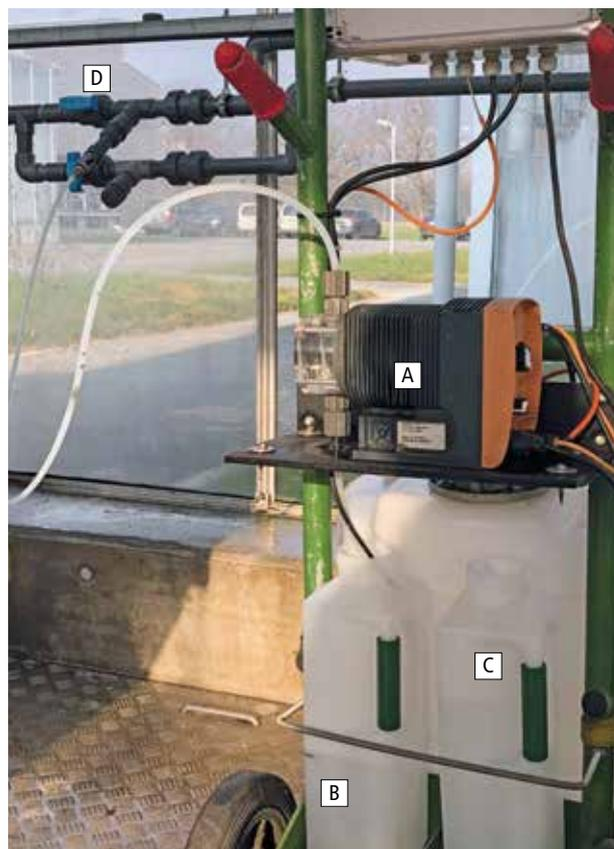
Figure 1 | Système d'injection utilisé dans les essais constitué d'une pompe volumétrique (A), d'un bac pour la bouillie (B) et pour le rinçage des tuyaux (C). Point d'injection dans le tuyau du système d'irrigation (D).
