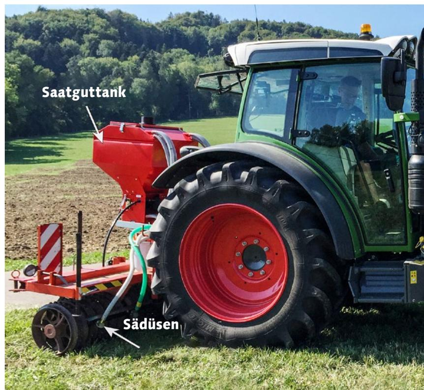
neu entwickelte automatische Verfahren besitzt in jeder Saatgutleitung direkt über den Sädüsen ein Y-Ventil, wodurch das Saatgut entweder im Zirkulations-Modus wieder zurück in den Saatguttank oder dann zu den Sädüsen geleitet wird. Dadurch ist sichergestellt, dass jederzeit bei allen acht Ventilen die eingestellte Saatmenge zur Verfügung steht.
