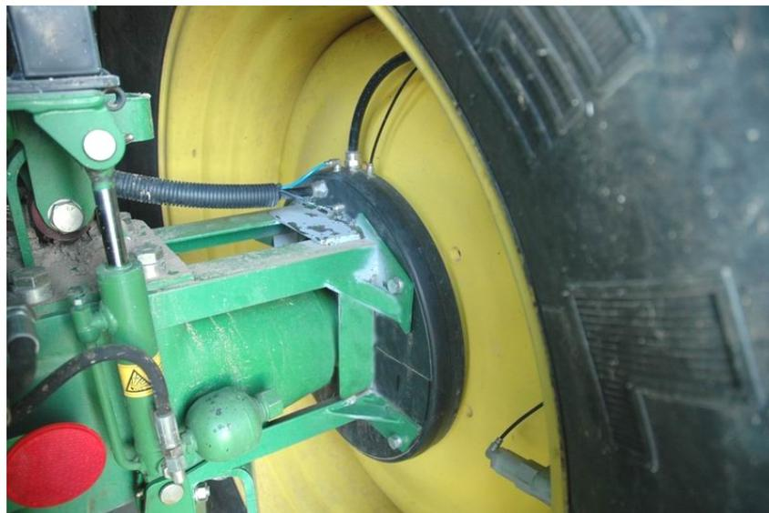
Mit Reifendruckregelanlage können unterschiedliche Bedürfnisse auf Strasse und Feld angegangen werden.
