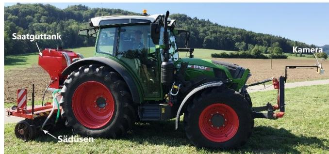
Abbildung 1: Sämaschine auf Cambridgewalze mit Kamera in Front
