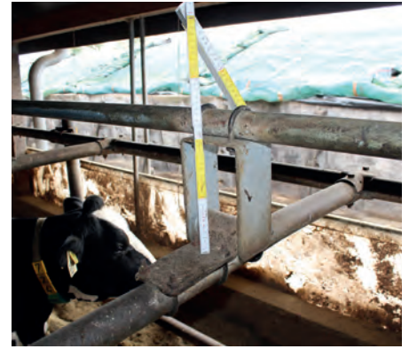
Variante Winkelkonstruktion zur Nackenrohrerhöhung.
