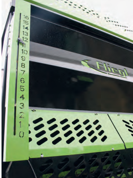
Anzeige an der Vorderwand des Streuers für die Öffnungsweite zwischen Laderaum und Streuwerk.
