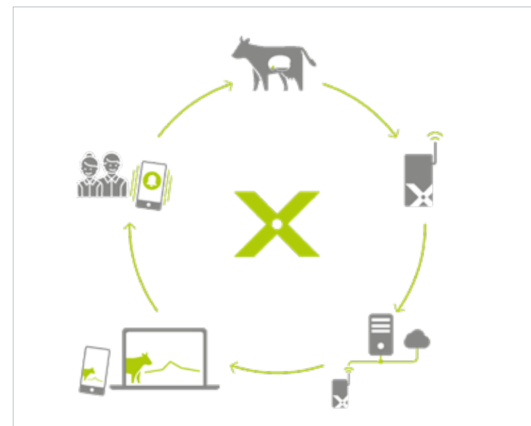
Abbildung 3: Die vom smaXtec Bolus erfassten Daten werden von der Base Station ausgelesen und an die smaXtec Cloud übertragen, wo sie ausgewertet und verarbeitet werden. Auf diese Weise erhalten die Landwirte wertvolle Informationen und können frühestmöglich handeln. (©smaXtec)
