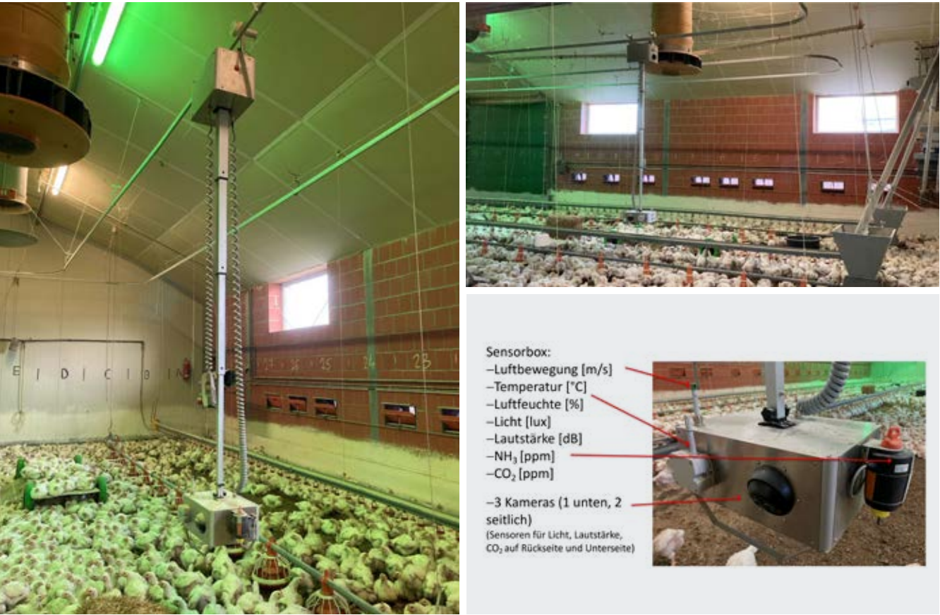
Abbildung 1: Farmer Assistenz System (FAS), auch „Chickenboy“ genannt, auf der Laufschiene in einem Broilerstall (Fahrtrichtung nach rechts) und unten angebrachter Sensorbox (Fotos: Jörg Hartung).
