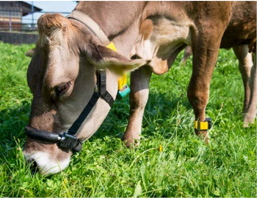
Abbildung 1: Kuh mit RumiWatch Halfter (Itin+Hoch, Liestal, Schweiz) zur Messung des Kauverhaltens, RumiWatch Pedometer zur Messung der Bewegungsaktivität und einem Halsband mit integrierter Tieridentifikation (GEA, Düsseldorf, Deutschland). (Foto: Gabriela Braendle, Agroscope).
