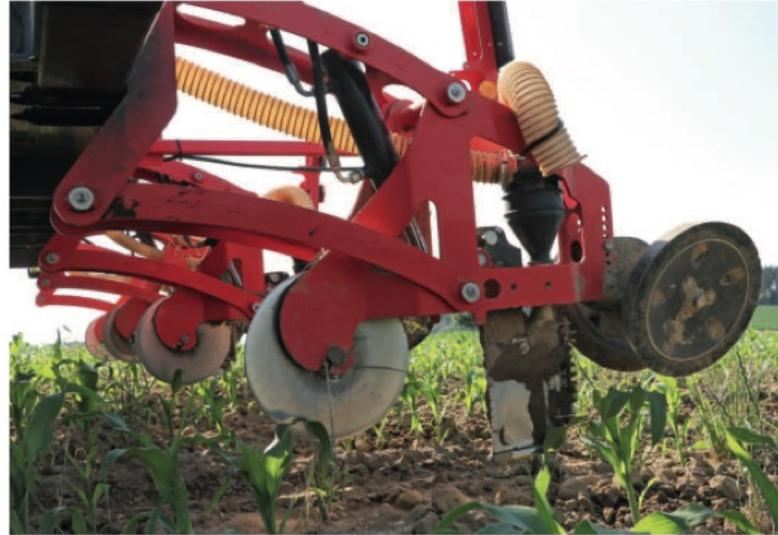
In einem Parallelogramm hängen Sech, Schar und Andruckrolle.
