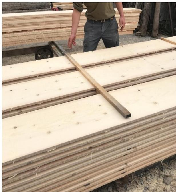
Figure 6: entreposage des planches
