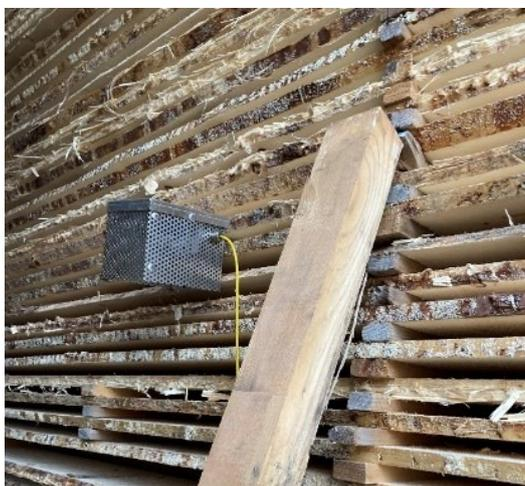
Figure 8: contrôle de l'humidité des tablards
