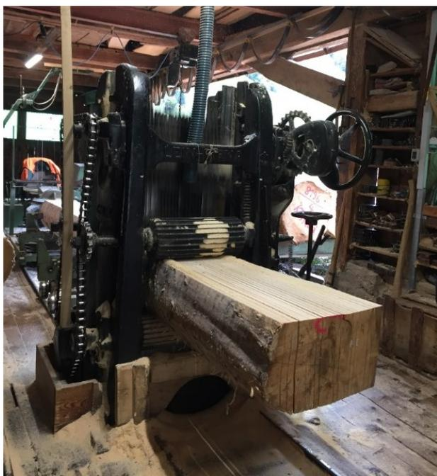
Figure 7: délignage des planches
