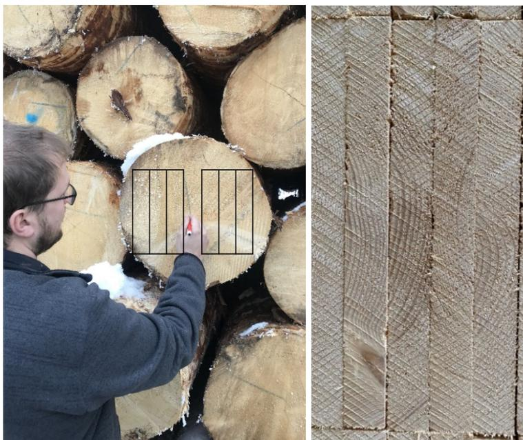
Figures 4 et 5: exemple de traçage des planches à bois dans un billon
