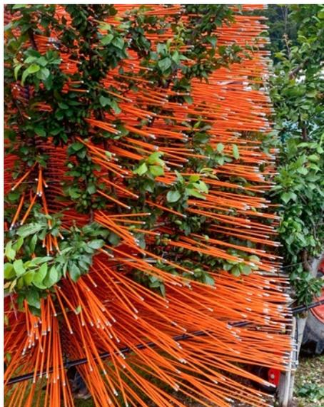
Abb. 1: Knapp 3000 Glasfaserstäbe rotieren durch die Laubwand und streifen Jungfrüchte ab. (© Agroscope)
