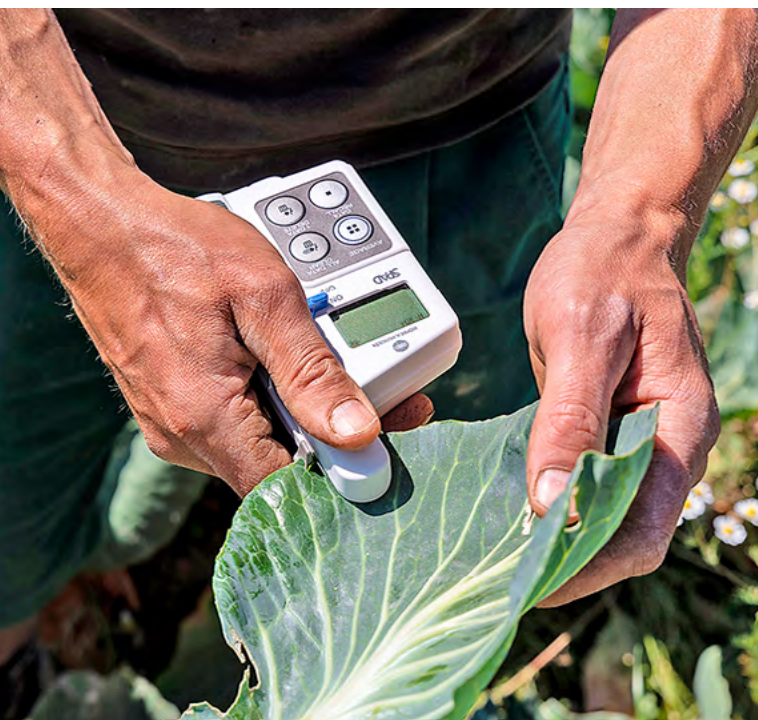
Abb. 1 | Messung der Chlorophyllabsorption mit dem SPAD-Messgerät an Weisskohl. (Foto: Michael Gugger, Agroscope)
