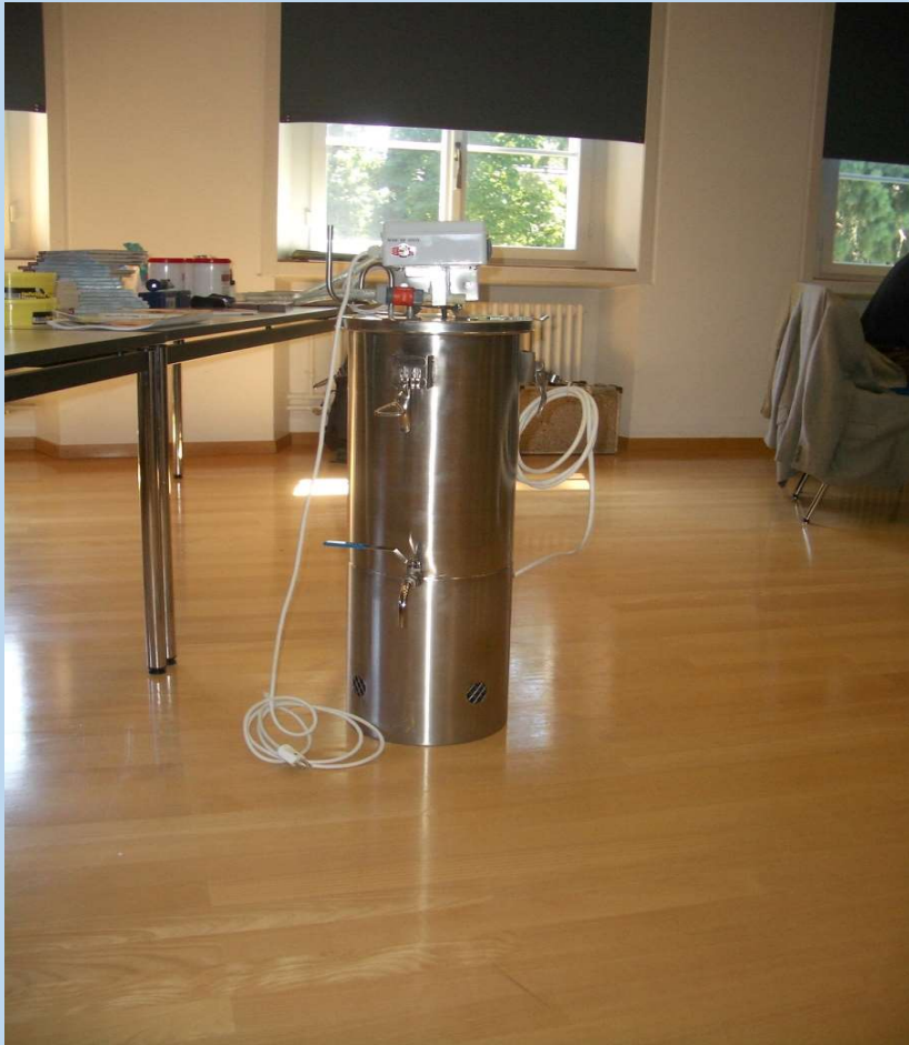
Kleiner Acetator, Fa. Frings mit Belüftung und Säuremessung
