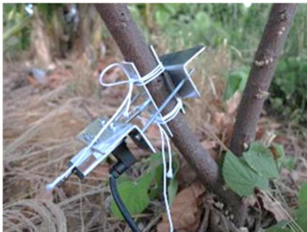
Figura 22: Dendrômetro medindo a variação do diâmetro caulinar de um ramo principal da árvore.
