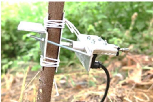
Figura 66: Dendrômetro Megatron (potenciômetro linear, fixação construída pela Agroscope).
