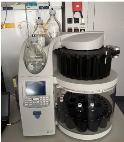
Abb. 13: Thermo Fischer ASE350 zur Extraktion von PSM aus Bodenproben
