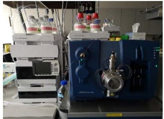
Abb. 14: Agilent LC-System und AB Sciex-QTRAP 5500 TQ Massenspektrometer
