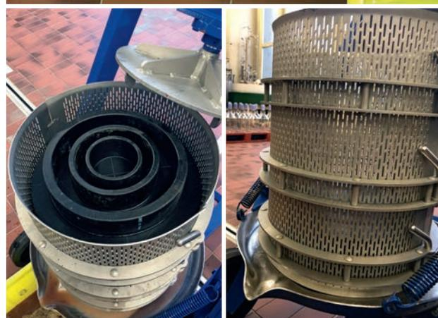
Figure 1 | Pressurage des baies à l'aide d'un pigeur, puis d'un pressoir 0,68 hl à piston vertical (TomPress).
