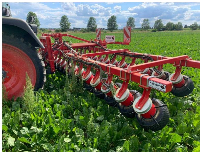
Fig.1 – Désherbeur à pneus de la marque Klünder.
