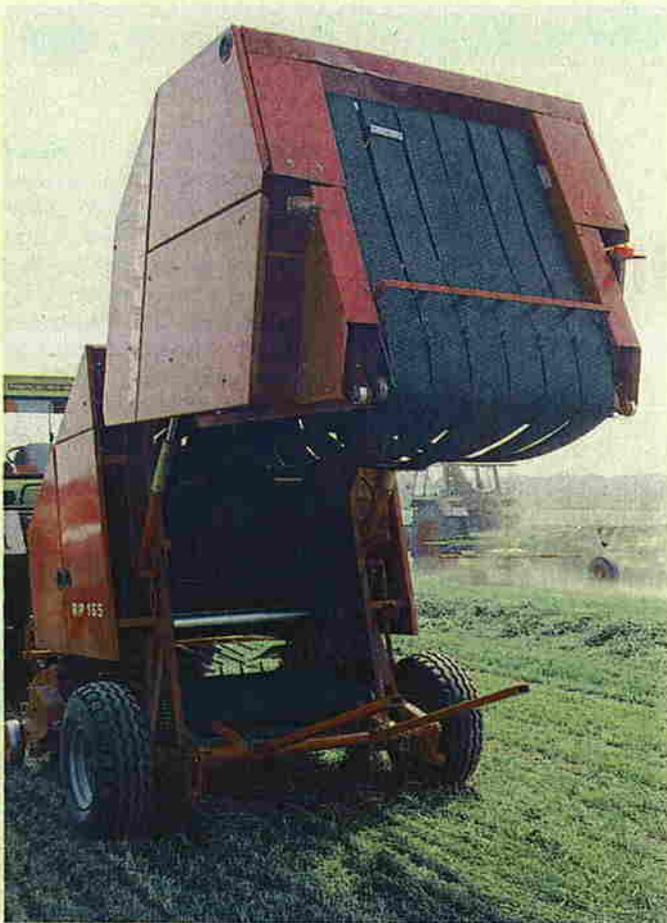
Rundballenpresse mit variabler Presskammer.
