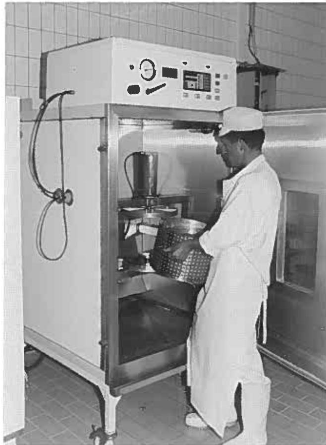
Die Käsepressen sind in Klimaschränken montiert, damit der Temperaturverlauf von Käsen in Originalgrößen simuliert werden kann
