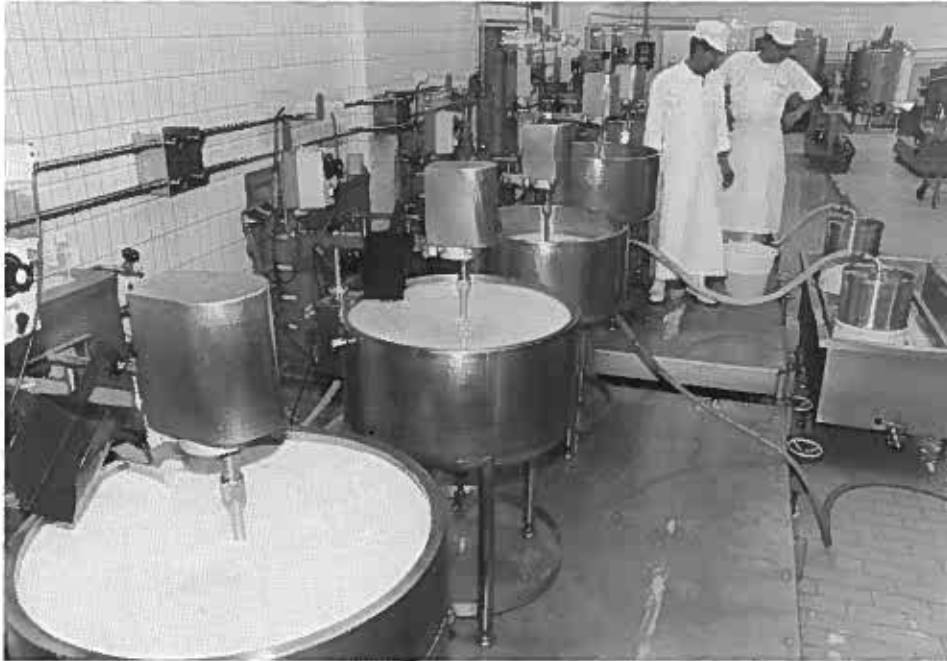
Modellkäserei der FAM: alle Gerätschaften und Maschinen sind mobil
