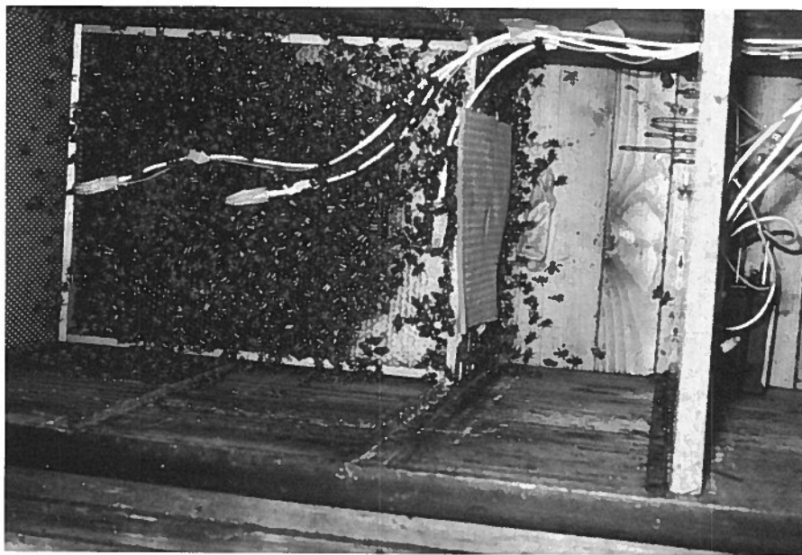
Sondes pour les prises d'échantillons d'air dans une ruche suisse. Dans notre essai nous n'avons utilisé que la sonde du milieu, placée dans le nid à couvain.
