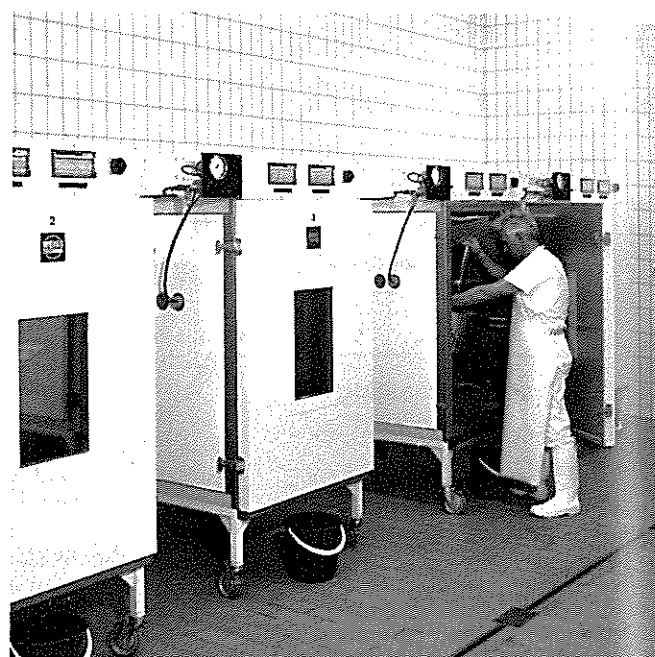
Abb. 5. Beim Pressen der Modellkäse (nach der Fabrikation während 24 Std.) muss der Temperaturverlauf von Käsen in Originalgrösse simuliert werden, damit die Milchsäuregärung entsprechend verläuft. Deshalb sind die Käsepressen in Klimaschränken montiert. Diese Anordnung erlaubt auch Temperatur- und Pressversuche.
