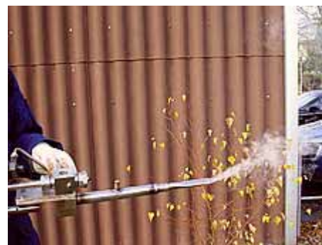
Fig. 2: Forte fuoriuscita dell'acido ossalico sublimato grazie al ventilatore
