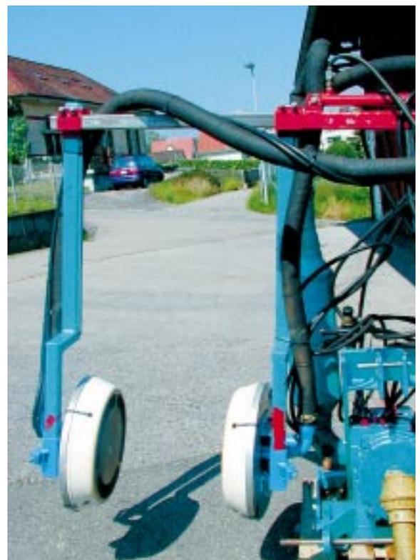
Abb. 2: Gerät Galvit: In den beiden weissen Auslaubköpfen sind die rotierenden Luftdüsen angebracht.
