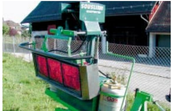
Abb. 5: Gerät Souslikov: Der Brenner erzeugt genügend Hitze um die Blätter zu denaturieren.
