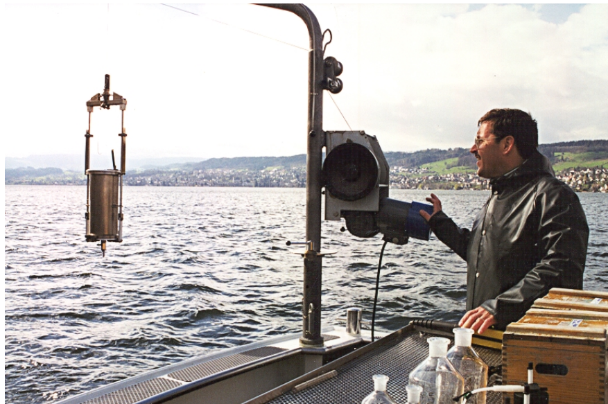
Figur 6: Probenahme auf dem Zürichsee durch Mitarbeiter der Wasserversorgung Zürich. Das Probenahmegerät (links) wird mit dem Kran zurück an die Wasseroberfläche gehoben. Im Vordergrund: Tisch mit vorbereiteten Probeflaschen.
