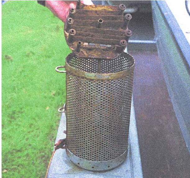
Figur 14: SPMD (zick-zack-förmig aufgespannt im oberen Teil des Bildes) und Metallbehälter nach der Exposition im Greifensee. Bevor die angereicherten Stoffe rückextrahiert werden können, muss die Membran sorgfältig von Schmutz und Algenbewuchs gereinigt werden.
