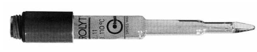
Abbildung Nr. 5 : Glaselektroden mit Gelelektrolyt (Firma Mettler-Toledo vormals Ingold)
