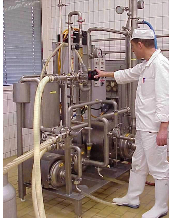
Abb. 2: MF-Pilotanlage (ALP) vom Typ Alcross M der Firma Tetra Pak.
