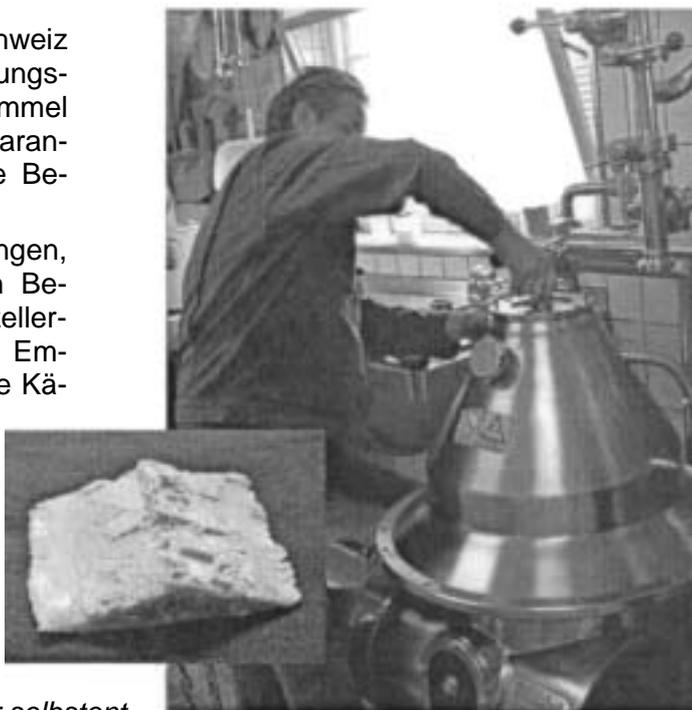
*Rückstände aus einer selbstentleerenden Zentrifuge*
