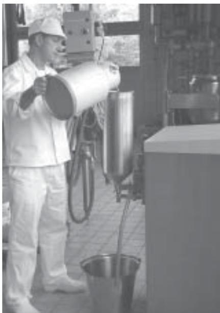
Abb.1. Mit diesem Homogenisator wurde der Ziger in Wasser suspendiert
