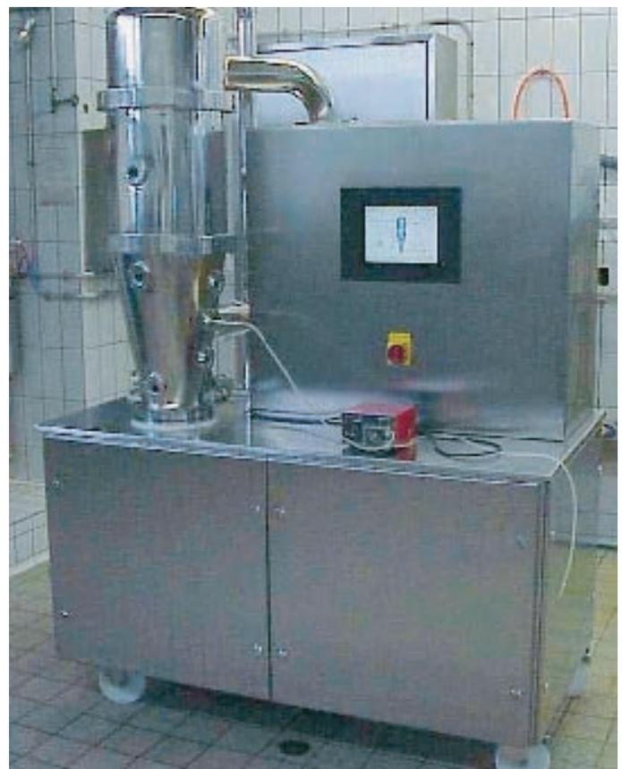
Die Kulturen wurden mit diesem Wirbelschichttrockner WFP-1 (DMR, Kaiseraugst) getrocknet. (Bild: ALP)
