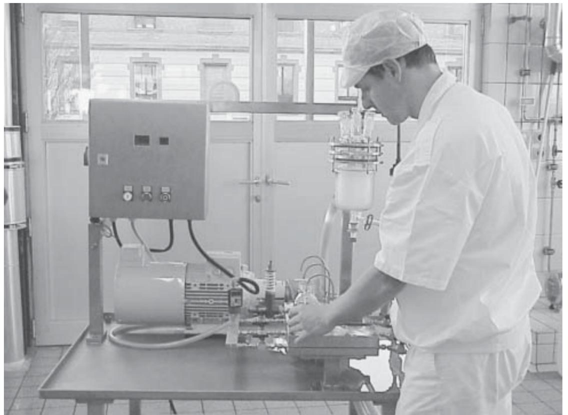
Ein NF-Tischmodell, wie es für die von ALP und SHL durchgeführten Arbeiten eingesetzt wurde (Bild: ALP)
