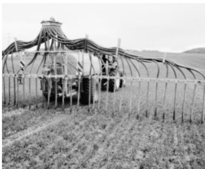
Abb. 3: Der pneumatische Düngerstreuer verteilte den Mineraldünger und der Schleppschauchverteiler die Gülle auf den Versuchspartellen.
