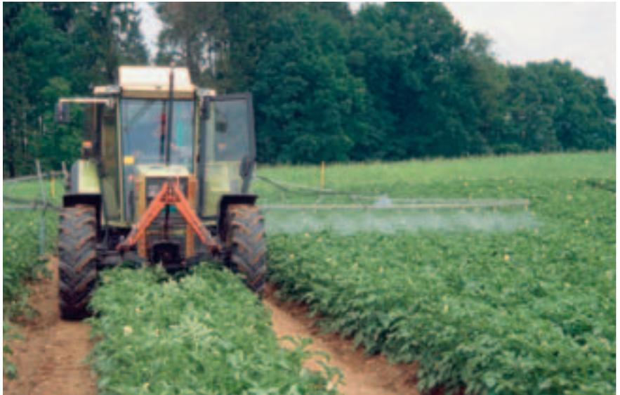
Abb. 18: Fahrgassen (75 cm RA) für das Spritzen und Düngen sind bei 90 cm RA nicht erforderlich, da die breiteren Furchen Reifenbreiten bis zu 35 cm (14") zulassen.
