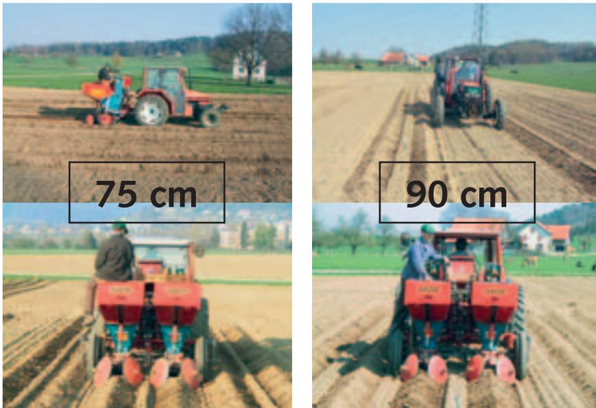
Abb. 7: Der Umbau dieses älteren Legeautomaten für einen wechselnden Einsatz bei 75 cm und 90 cm RA war relativ arbeitsaufwändig. Die Maschine war ursprünglich nur für eine Anpassung von 62 cm bis 75 cm RA vorgesehen. Bei vierreihigen Altmaschinen dürfte ein Umbau kaum in Frage kommen.
