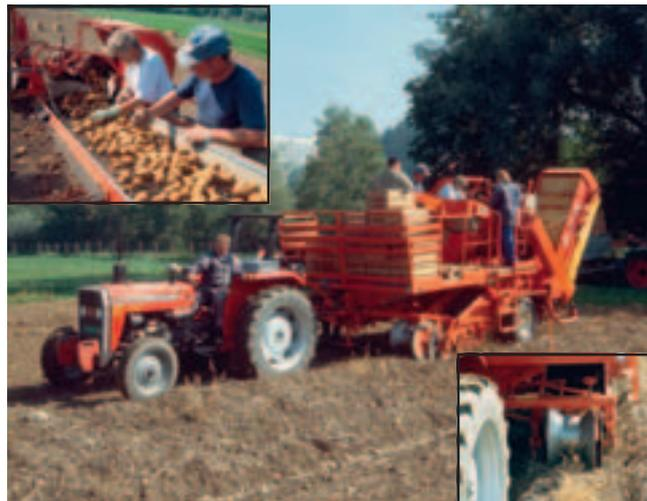
Abb. 14: Der Ernteaufwand wird vor allem durch die pro Flächeneinheit auszulesenden Rodegutteile (Steine, Kluten, Krautteile und Kleinkartoffeln) bestimmt. 90 cm RA bedingt in der Regel eine Anpassung der Rodeaggregate.
