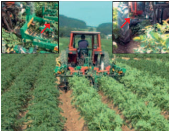
Abb. 12: Hacken/Anhäufeln beim letzten Pflegedurchgang mit grossen Dammformblechen bei 90 cm RA. Durch die höheren Dämme und Pflanzen entstanden in diesem Falle mehr Berührungen (= kleine Pflanzenverletzungen; Pfeile) zwischen Maschinenteilen und Kartoffelstauden.
