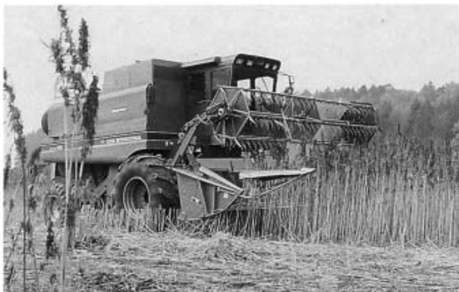
Abb. 16. Besonders beim Einsatz von herkömmlichen Mähdröschern ist zunächst entscheidend, dass der Erntetermin nicht allzu lange hinausgeschoben wird, da sich sonst hohe Ausfallverluste und technische Probleme einstellen können.
