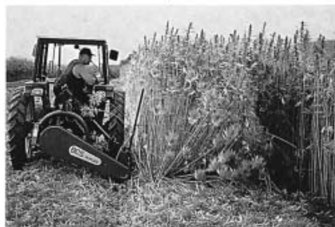
Abb. 14. Einfache Balkenmäherwerke können für das Hanfmähen eingesetzt werden (a). Für einen störungsfreien Betrieb musste ein spezielles Schwadbaleh konstruiert werden (b). Nachteilig sind die relativ geringe Arbeitsbreite und die Einschränkungen bei der Langpflanzenernte vor allem auf die Bergeverfahren und die Aufbereitungstechnik.
