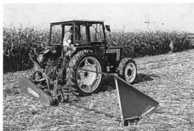
Abb. 14. Einfache Balkenmäherwerke können für das Hanfmähen eingesetzt werden (a). Für einen störungsfreien Betrieb musste ein spezielles Schwadbaleh konstruiert werden (b). Nachteilig sind die relativ geringe Arbeitsbreite und die Einschränkungen bei der Langpflanzenernte vor allem auf die Bergeverfahren und die Aufbereitungstechnik.
