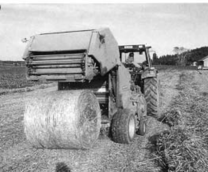
Abb. 12. Rundballenpressen (a) sind auch für die Bergung von Langpflanzenstroh geeignet. Da Schneidvorrichtungen bisher den Dienst versagten, bedingen Quaderballenpressen infolge der hohen Kolbenbeanspruchung für den Dauereinsatz eine Einkürzung der Pflanzen (b).
