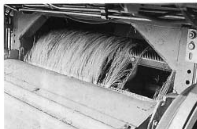
Abb. 18. Bei später Ernte tendieren die Stengel sehr stark zum Auffasern. Bei starken Wicklungen an der Dreschtrommel muss der Mähdrusch mit Tangentialdreschwerken eingestellt werden.
