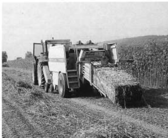
Abb. 12. Rundballenpressen (a) sind auch für die Bergung von Langpflanzenstroh geeignet. Da Schneidvorrichtungen bisher den Dienst versagten, bedingen Quaderballenpressen infolge der hohen Kolbenbeanspruchung für den Dauereinsatz eine Einkürzung der Pflanzen (b).
