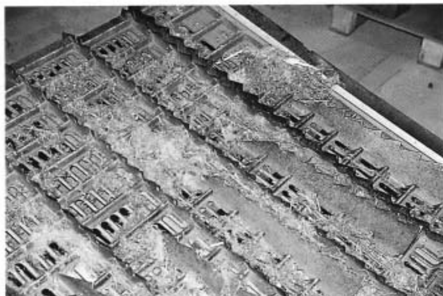
Abb. 17. Vor allem bei grünen Pflanzen müssen kritische Stellen (zum Beispiel Schüttleroberfläche) im Mähdrescher immer wieder überprüft und allenfalls gereinigt werden.
