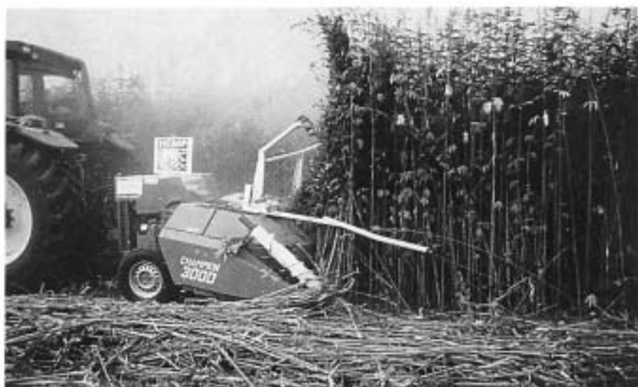
Abb. 15. Die HempFlax-Erntetechnik hat sich bereits in verschiedenen Anbaubereichen im Ausland gut bewährt. Die Pflanzen werden nach dem Schnitt leicht geknickt und auf 60 cm eingekürzt (a). Der lockere Schwad (b) wird nicht gewendet, sondern mit einem speziellen Pickup-Gerät mehrmals gelüftet.
