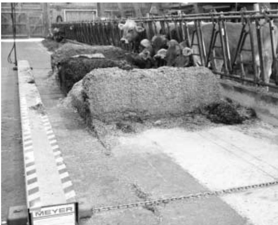
Abb. 1: Der Futternvorschieber bewegt die Siloblöcke per Knopfdruck den Kühen entgegen. So kann er bis 2,5 Kühe pro Fressplatz versorgen.
