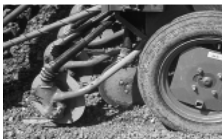
Fig. 3: La mise en place de la culture avec un semoir équipé d'un soc à disque, après un à deux passages avec la herse à bèches roulantes, constitue un procédé très favorable qui a fourni de bons résultats.
