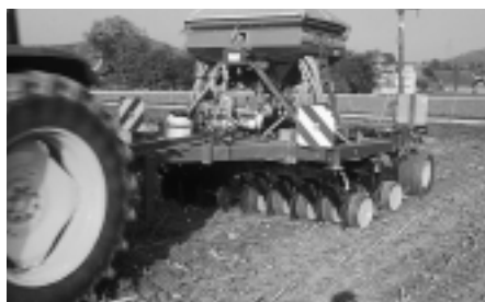
Fig. 4: Le semis direct avec des socs à disque présente un avantage important: les socs ne risquent pas de s'obstruer. Mais la forte pression exercée sur le disque peut entraîner des tassements au niveau du sillon, ce qui peut avoir des conséquences négatives sur la levée.
