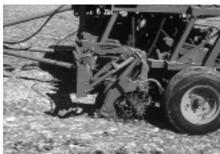
Fig. 5: Le semis direct avec des socs à dent rigide ouvre un sillon pour les semences et ne risque pas d'y comprimer de la paille. Ce système est toutefois plus sensible aux bourrages que les socs à disque.
