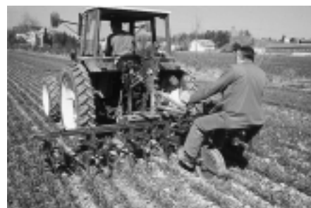
Fig. 11: Les sarclouses déracinent les adventices et les hachent efficacement. Les sarclouses-étoiles (à gauche) ne connaissent pas les bourrages mais exigent des rangées plus espacées que les sarclouses à socs en pattes d'oie (à droite).
