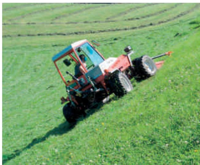
Abb. 10: Der Einsatz des Zweiachsmähers lohnt sich erst bei genügend hoher Auslastung. (Foto: Agroscope ART)
