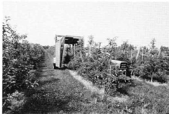
Rechts: Mit dem Tunnel-Recyclinggerät mit zwei hydraulisch angetriebenen Querstromgebläsen mit stufenlos regelbarer Luftleistung werden eine gute Mittelanlagerung und eine erhebliche Reduktion der Abdriftverluste und somit eine 30%-Mittelleinsparung/Jahr erreicht (Joco: Preis zirka Fr. 35 000.-).
