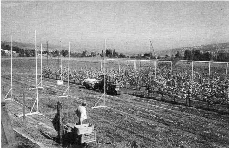
Abb. 11. Die Abdriftverluste wurden mittels Filterpapierstreifen an waagrechten und senkrechten Holzlatten bei voller Belaubung erhoben (Bild: Messungen bei der Blüte).
