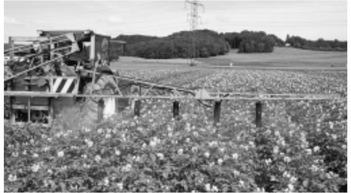
Abb. 6: Mit der Unterblattspritzeinrichtung wurden die Blätter und Stengel von jeweils zwei unten platzierten Düsen pro Element und von oben recht gleichmässig behandelt (Prototyp).
