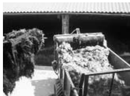
Abb. 21: Die direkte Beschickung der Streuer beim Entmisten der Buchten ist sicher die rationellste Methode der Laufstallmistausbringung, doch hat sie den Nachteil, dass das Streuwerk sehr stark beansprucht wird. Auch ist ein gleichmässiges Beladen mit Hof- oder Frontlader kaum möglich.
