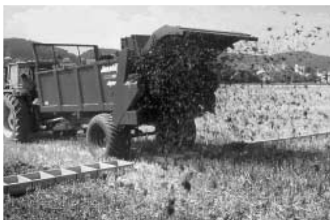
Abb. 1: Mist und Abfalldünger sollten in der empfohlenen Menge, exakt und fein verteilt sowie bodenschonend ausgebracht werden können. Streuversuche im Feld dienten dazu, die Eignung verschiedener Streusysteme abzuklären.
