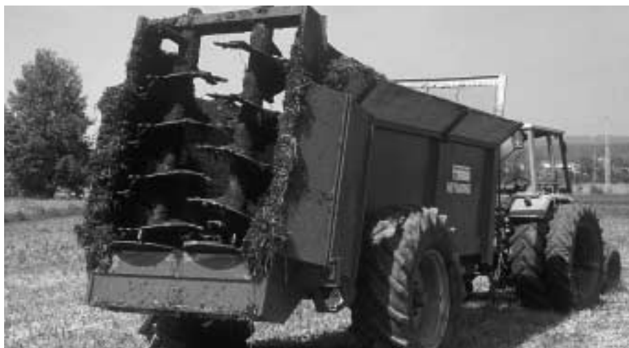
Abb. 18: Die mit Tiefgangachse gebauten Muldenstreuer sind dank ihres robusten Streuerwerkes mit zwei grossen Vertikalwalzen für die Ausbringung von Laufstallmist konzipiert. Sie haben aber ein beträchtliches Leergewicht.
