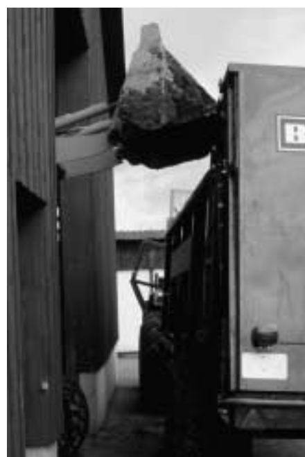
Abb. 14: Bei Streumaschinen mit grosser Bauhöhe müssen die zum Einsatz gelangenden Front- und Hoflader genügend Hubhöhe haben, damit eine rationelle Beschickung möglich ist.
