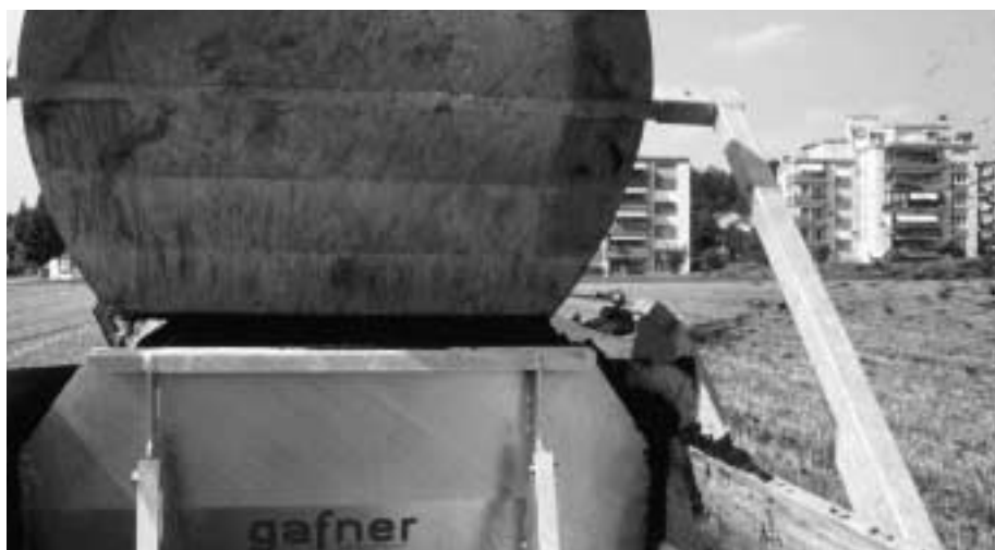
Abb. 19: Seitenstreuer ergeben dank der Schiebewand eine gute Längsverteilung, sind hangtauglich und eignen sich für verschiedenste Streumaterialien. Der Leistungsbedarf für den Antrieb des Streuerwerkes ist allerdings recht hoch.
