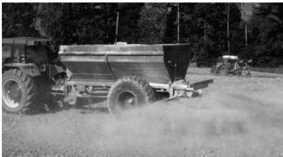
Abb. 20: Für die exakte Dosierung und Verteilung von Ricokalk eignen sich spezielle Grossraumstreuer mit Bandboden und Zweischeibenstreuerwerk am besten.
