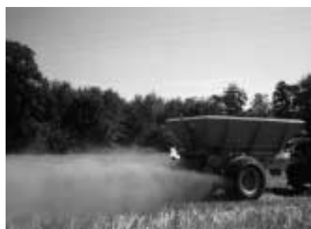
Abb. 22: Getrockneter Klärschlamm verursacht beim Streuen mit Scheibenstreuern eine hohe Staubentwicklung, besonders wenn das Streugut eine ungünstige Korngrössenverteilung aufweist (Bild links). Mit einer Streuschnecke ausgerüstete Grossraumstreuer dagegen können auch mehligte Dünger weitgehend staubfrei und mit exakter Querverteilung ausbringen.
