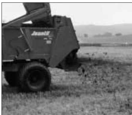
Abb. 3: Die während des Streuvorgangs hochgefahrte Stauklappe streicht die Ladung vor dem Streuwerk ab. Dadurch ergibt sich eine gleichmässige Entladung und Längsverteilung.
