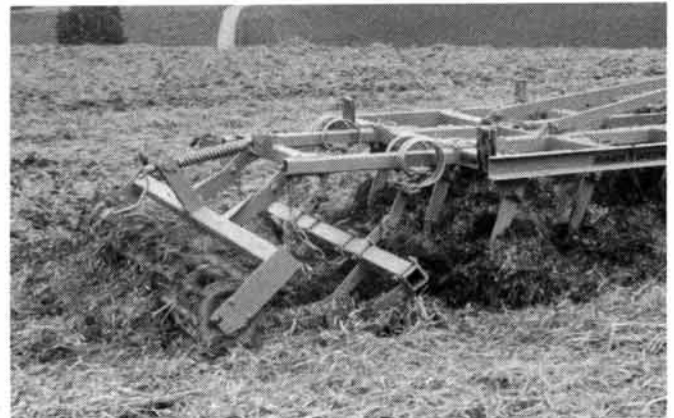
Abb. 4: Nachläufer krümeln und ebnen den Boden ein. Im Gegensatz zur Messerrollegge (RabM links) rückverfestigt die Schleppe mit Flachstabwalze den Boden (RabW rechts).
