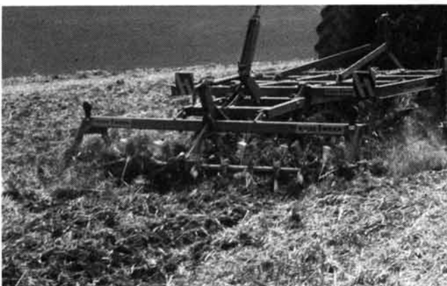
Abb. 4: Nachläufer krümeln und ebnen den Boden ein. Im Gegensatz zur Messerrollegge (RabM links) rückverfestigt die Schleppe mit Flachstabwalze den Boden (RabW rechts).
