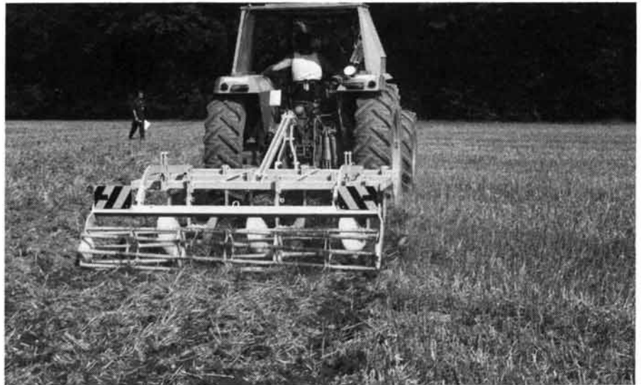
Abb. 9: Der Scheibengrubber (Lemk) bewirkt bei flachen Arbeitstiefen eine ganzflächige Arbeit, was sich für die Unkrautbekämpfung günstig auswirkt. Die Durchmischung des Bodens durch die Zinken in Kombination mit Scheiben befriedigt bei Arbeitstiefen bis ca. 15 cm gut.
