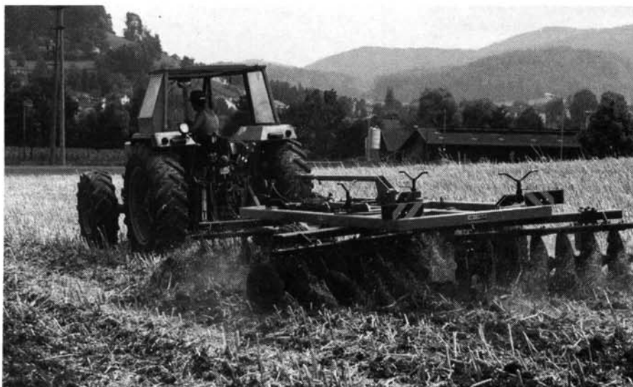
Abb. 15: Die Scheibenegge (Quiv) schält den Boden ganzflächig, wodurch Unkraut gut erfasst wird. Die Stützräder erlaubten immer eine exakte Tiefenführung.
