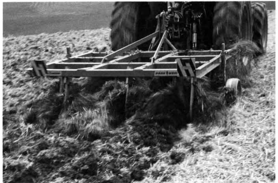
Abb. 3: Der Doppelherzschargrubber (RabO) zeichnet sich durch eine gute Durchmischung des Bodens aus.
