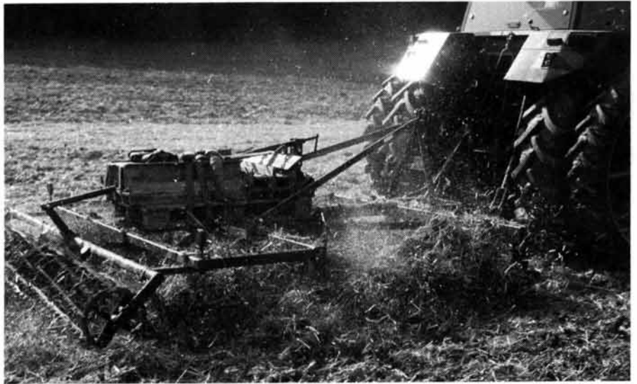
Abb. 12: Langes Stroh kann sich bei der Spatenrollegge (Kron) auf die Wellen aufwickeln, kurz gehäckseltes Stroh kann hingegen ohne Probleme eingearbeitet werden. Das Zusatzgewicht (in diesem Fall 420 kg) erhöht die Arbeitsintensität wesentlich.
