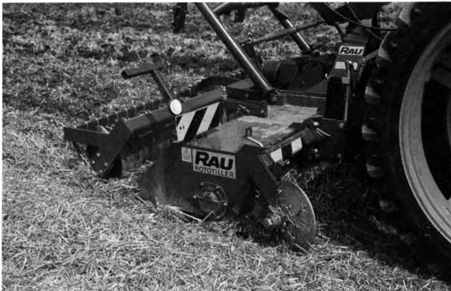
Abb. 18: Der Zinkenrotor (Rau) bearbeitet den Boden ganzflächig und intensiv. Eine möglichst hohe Fahrgeschwindigkeit und eine möglichst niedrige Rotordrehzahl sind mit den zapfwellengetriebenen Geräten generell einzuhalten.
