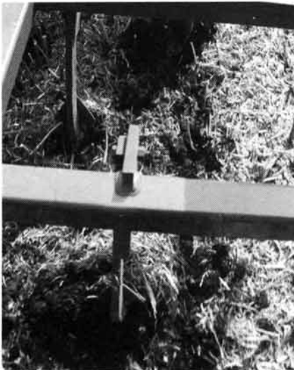
Abb. 2: Flache Arbeit führt beim Doppelherzschargrubber (RabO) ohne Nachläufer zu Rillenbildung. Der Boden wird nicht ganzflächig bearbeitet.
