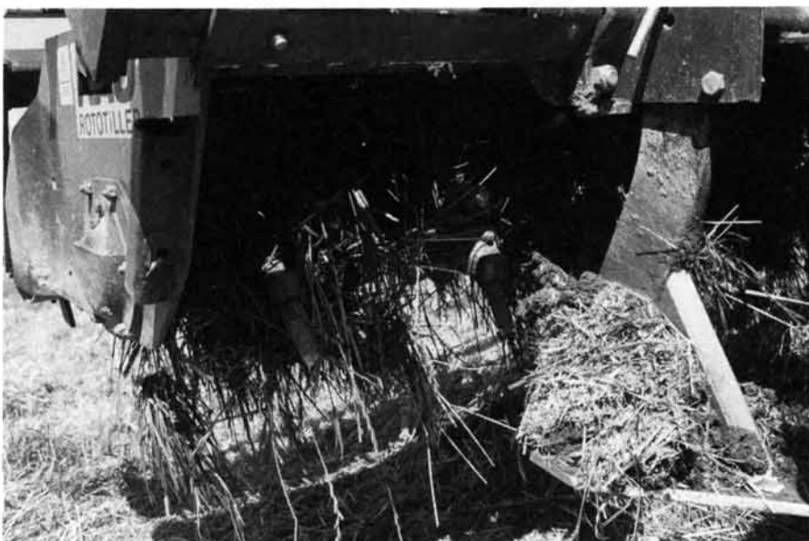
Abb. 19: Der Vorbaugrubber (Rau) führt den Zinkenrotor auch bei grösseren Fahrgeschwindigkeiten auf konstanter Tiefe, vermindert die Abnutzung der Zinken, kann aber beim Vorhandensein von gehäckseltem Stroh zu Verstopfungen führen.
