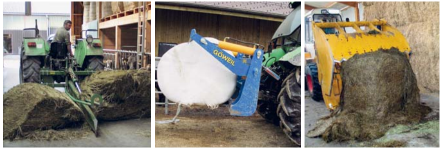
Abb. 6: Drei verschiedene Typen von Rundballenschneidern: Rundballenzerteiler mit schwertartigem Messer (Bild links); Entnahme und Transport der Rundballen mit dem Rundballenschneider (mittleres Bild); Silageschneidezangen mit entsprechend grossem Öffnungswinkel können auch Rundballen schneiden (Bild rechts).
