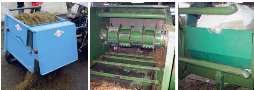
Abb. 10: Geschlossene Ballenauflösegeräte: Gezogenes Gerät (Bild links); Kratzboden als Vorschub und klingenbestückte Auflösewalze als Auflösewerkzeug (mittleres Bild); ein zusätzliches Blech ermöglicht das Auflösen von Maissilageballen bzw. Verteilen von losem Futter (Bild rechts).
