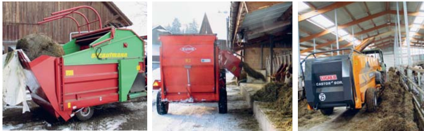
Abb. 11: Universalblockverteilwagen (UBVW) beim Beladen einer Rundballe mit der Ladeklappe (Bild links); Futtermittelverteilung mit Verteilwagen (mittleres Bild); Einstreuen einer Tretmistliegefläche über einen Auswurf (Bild rechts).
