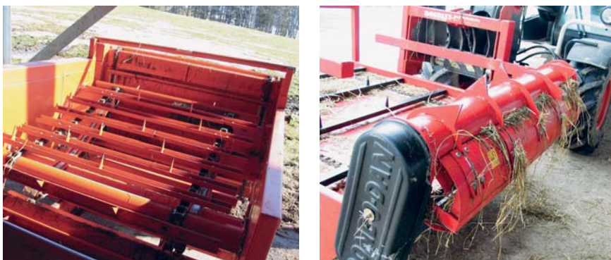
Abb. 9: Möglichkeiten zum Auflösen von Halmgut-Rundballen: Abweisstange und Kratzboden mit Zinken (Bild links); Kratzboden mit einfacher Reisswalze (Bild rechts).
