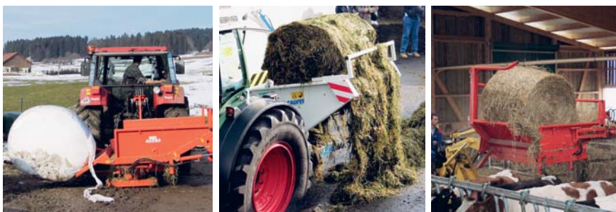
Abb. 8: Offene Ballenauflösegeräte: Beladen mit Ladearm (Bild links); Abwickeln und Vorlage von Silageballen mit einem Gerät im Dreipunktbau erfordert einen schweren Traktor mit entsprechender Hubkraft (mittleres Bild); Einstreuen von Liegeboxen mit einem offenen Ballenauflösegerät im Frontladeranbau (Bild rechts).
