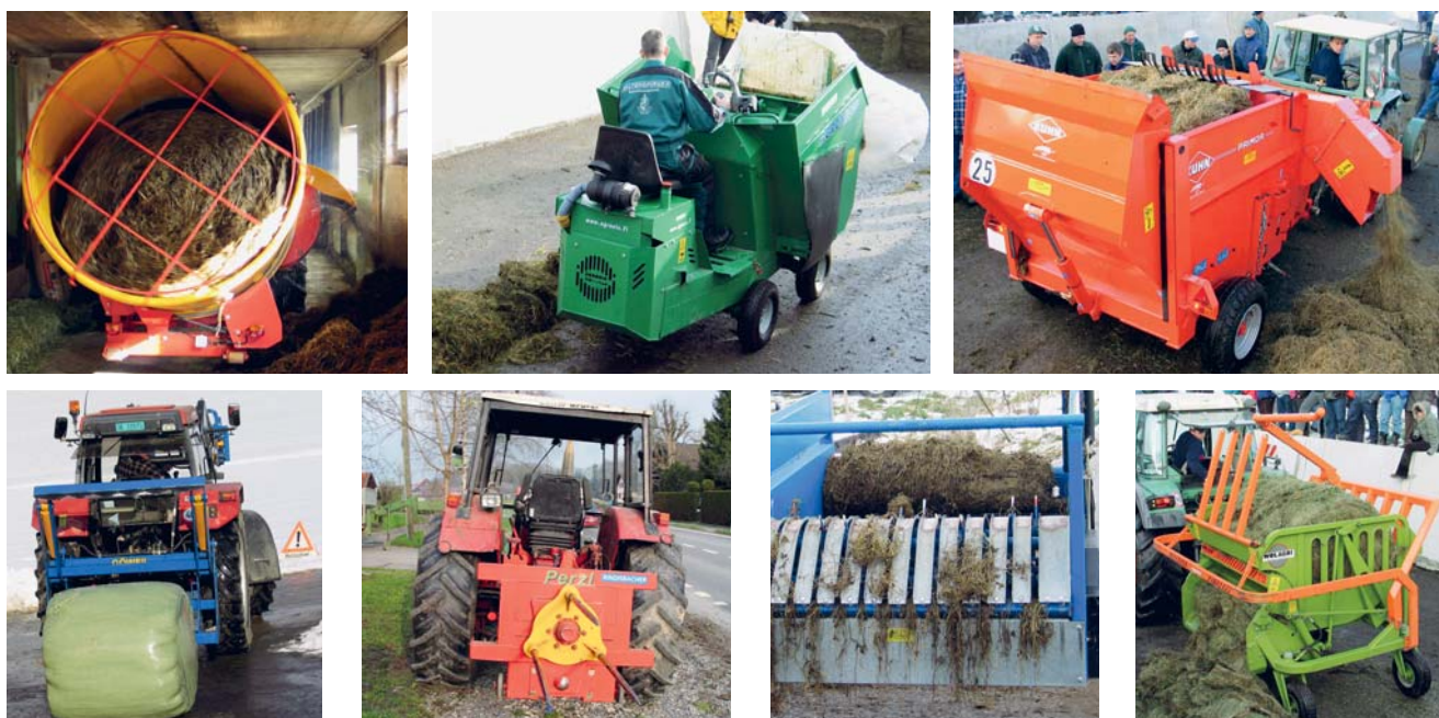
Abb. 1: Unterschiedliche Geräte erleichtern das Auflösen und die Vorlage von Rundballen. Bei der Wahl des passenden Geräts spielen Bestandesgrösse, Einsatzmöglichkeiten, Auslastung, Futterration, Futterlager, vorhandene Fütterungstechnik, Zugmaschine und räumliche Gegebenheiten eine grosse Rolle.
