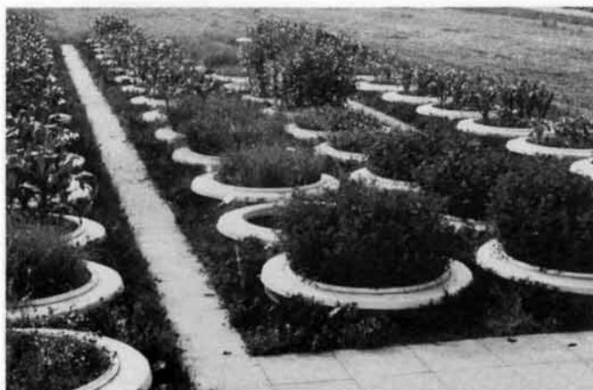
Abb. 1: Lysimeteranlage an der FAC in Liebefeld.
