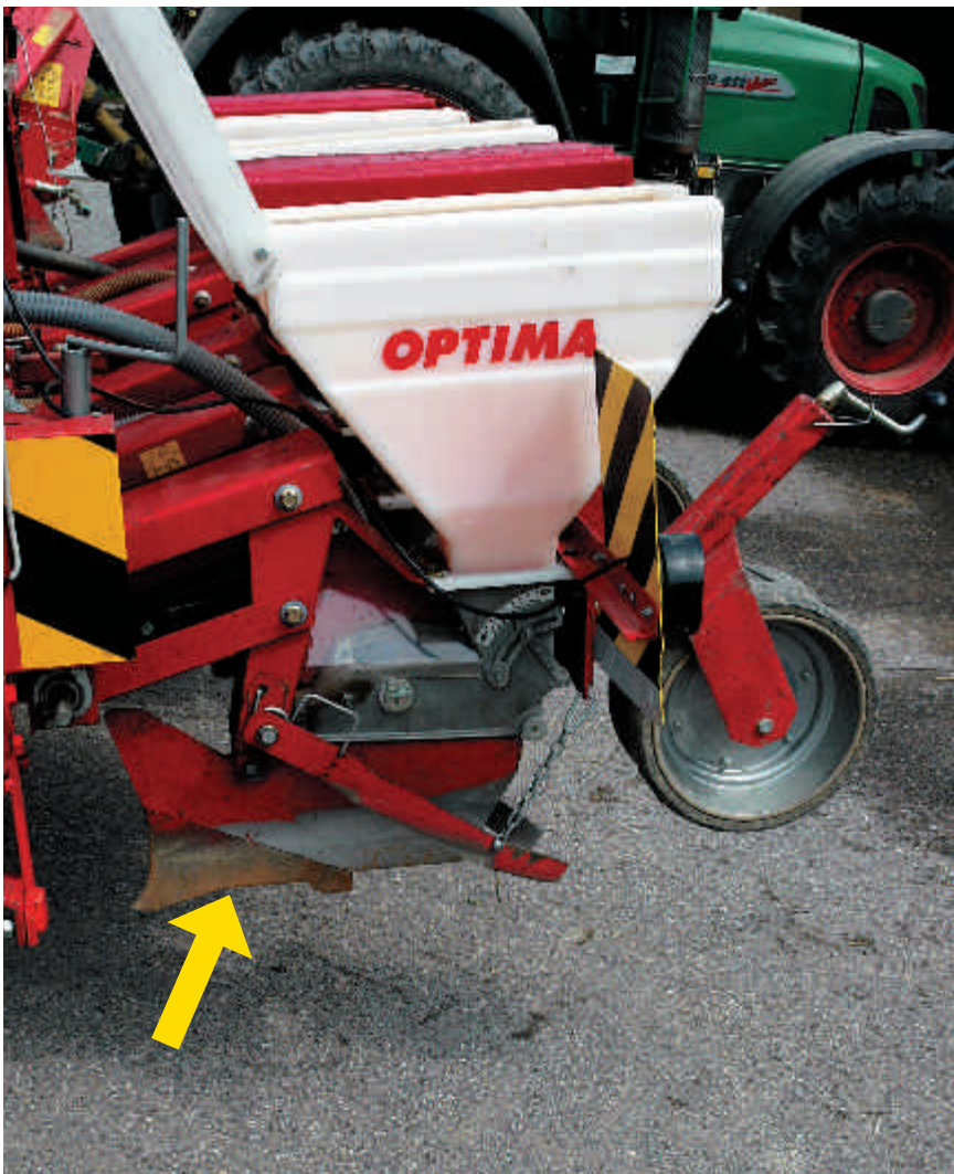
Fig. 9: Les socs à disques (en haut) ont le grand avantage de ne pas s'obstruer par rapport aux socs à dent rigide (en bas). Toutefois, si l'on applique une pression trop élevée sur les disques, le sillon peut se compacter fortement. Le soc à dent rigide a, lui, l'avantage de tracer le sillon sans le presser sous l'effet d'un poids élevé.
