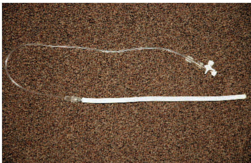
Fig. 2: Mesure du taux d'oxygène de l'air du sol à l'aide de tuyaux «Gore-Tex» perméables aux gaz (en bas) et d'un appareil mobile de mesure des gaz (en haut).
