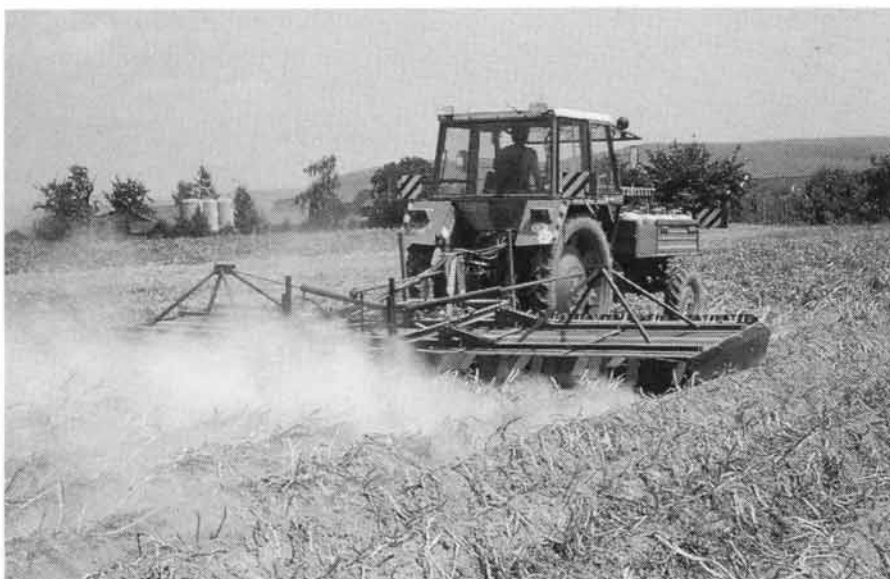
Fig. 4. La défaneuse thermique Schaffner (980 kg) a été utilisée avec un porte-outils 40 kW. Le gaz propane liquide est enflammé électriquement et entre en combustion dans 24 brûleurs. L'efficacité de ce système est contrebalancée par de nombreux effets secondaires indésirables, tels que les émissions de fumée etc.
