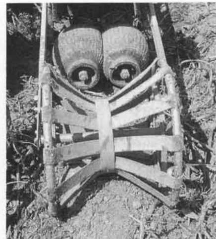
Fig. 1. Par combinaison de la défaneuse et de l'arracheuse, les fanes broyées sont déposées dans les sillons et les tiges restantes sont arrachées à l'aide de rouleaux en caoutchouc (tracteur 61 kW quatre roues motrices, pneus 11 pouces, prise de force 1000 t/min, Hürlimann 488 DT, 3610 kg + 1985 kg défaneuse et arracheuse Oldenhuis, Samro Burgdorf).
