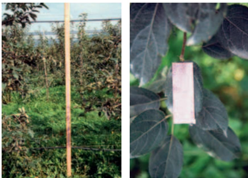
Fig. 6: La répartition verticale et le dépôt de produit sur les deux faces des feuilles (à droite) ont été contrôlés à l'aide de papier réagissant à l'eau.
