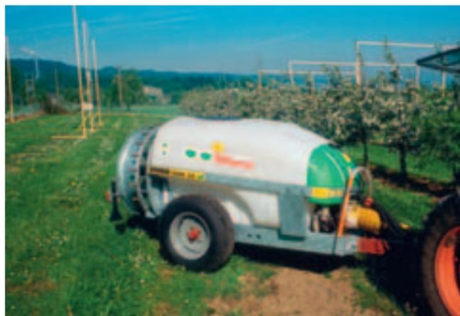
Fig. 2: Les plantations qui présentent un important volume d'arbres exigent que le débit d'air et la vitesse de progression de la machine soient bien adaptés. Un tel résultat peut être obtenu grâce au réglage manuel continu de l'angle des pales (Tifone).
