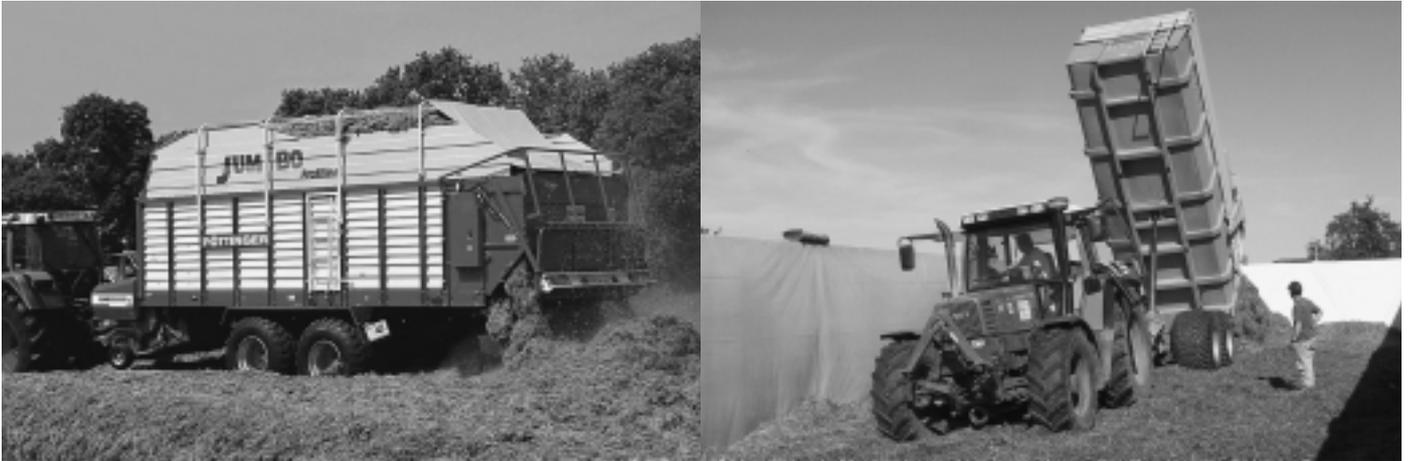
Fig. 17 et 18: Il existe différents procédés de déchargement dans le silo-couloir: l'autochargeuse avec fond mouvant, la remorque avec paroi mobile et la remorque à pont basculant. Le déchargement de l'ensilage avec autochargeuse et rouleaux-doseurs facilite la répartition et la compactage. Avec la remorque à pont basculant, il faut toujours veiller à ce que la surface soit la plus plane possible.
