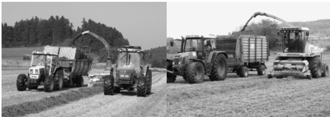
Fig. 12 et 13: Avec la récolteuse-hacheuse tractée, on utilise de plus en plus des véhicules circulant en parallèle. Pour obtenir des rendements très élevés à la surface avec des récolteuses-hacheuses automotrices, il faut de gros andains et des capacités de transport suffisantes.
