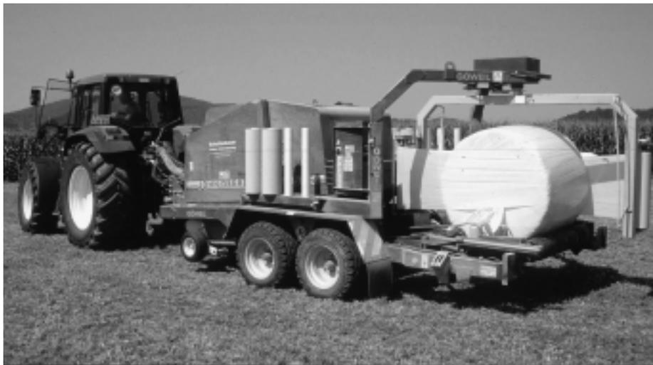
Fig. 23: Les combinaisons de presses et d'enrubannage sont très performantes et exigent peu de temps de travail. Il est préférable d'employer ce procédé sur des surfaces planes.
