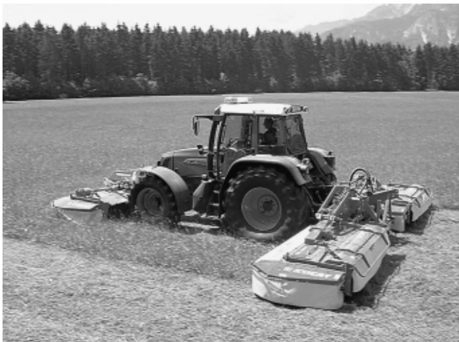
Fig. 2: Les faucheuses combinées permettent de mieux rentabiliser la puissance élevée des tracteurs.
