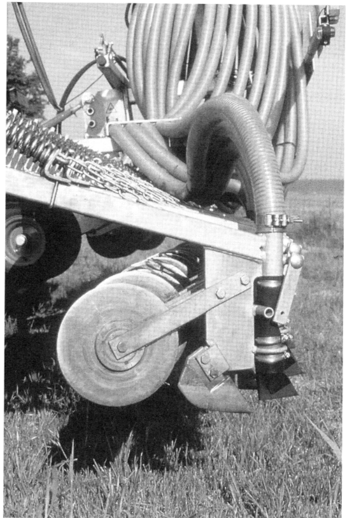
Abb. 10. Schlitzdrill auf Wiesen: In Abständen von 25 cm wird die Grasnarbe aufgeschnitten und die Schlitz mit Gülle gefüllt. Auf schweren, schlecht abgetrockneten Böden befriedigt die Arbeitsqualität nicht.
