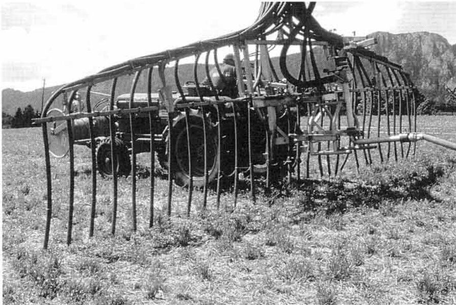
Abb. 8. Der Schleppschauchverteiler spielt seine Vorteile (konstante Arbeitsbreite, hohe Verteilpräzision) besonders im Ackerbau aus, kann aber ohne weiteres auch im Futterbau eingesetzt werden.
