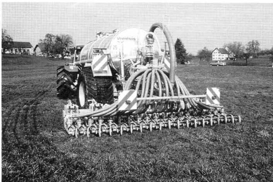
Abb. 13. Schlitzdrillmaschine (gezogene Ausführung): nur noch wenig Ammoniakverluste, doch was sagen unsere Böden zum Gesamtgewicht von über 14 t (ohne Traktor)?
