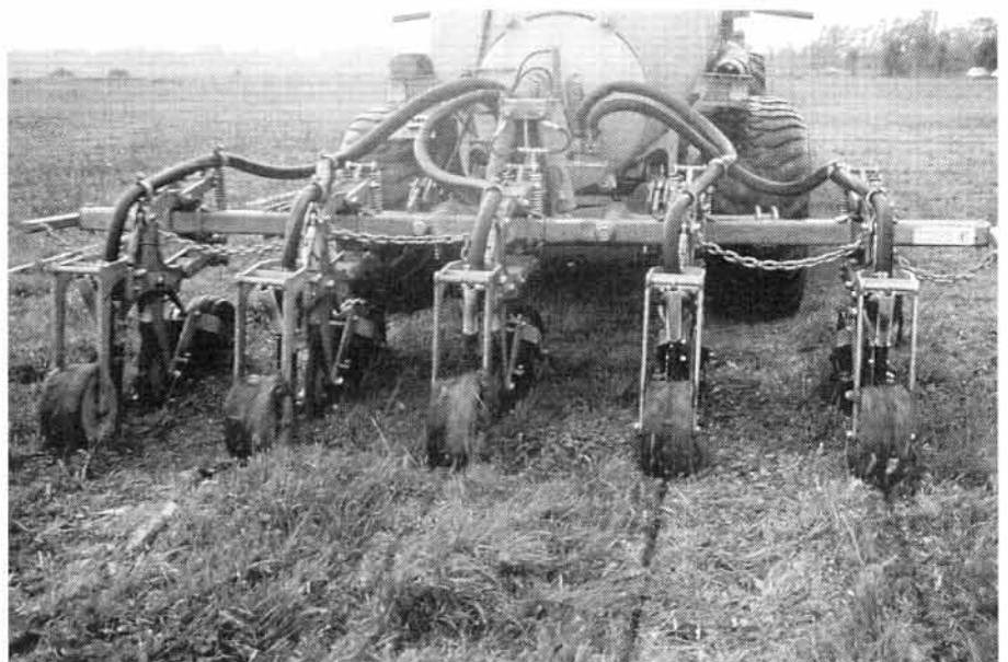
Abb. 12. Tiefinjektor auf Wiesen: Grosser Zugkraftbedarf, Gefahr von Schmier-schäden in kritischer Bodentiefe. Wegen den verbreitet schweren Böden ist die Technik bei uns nicht zu empfehlen.
