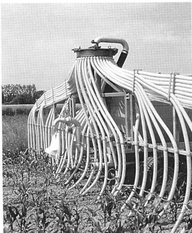
Abb. 1. Gehört die Zukunft dem Schleppschlauchverteiler? Wer die N-Verluste durch Ammoniakverflüchtigung markant reduzieren will, hat kaum eine andere Wahl.
