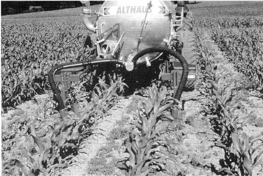
Abb. 11. Gülleeinleger im Mais (Tiefinjektion): Mit zwei starren Grubberzinken wird die Gülle bis 20 cm tief in den Boden geleitet. Dadurch lassen sich Ammoniakverluste praktisch unterbinden.
