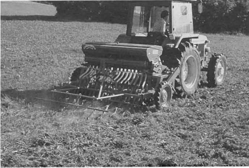
Fig. 11: Semoir en lignes avec le semoir direct Eurogreen: puissant, mais coûteux et peu adapté à la pente. De telles machines spéciales conviennent pour des régions à sécheresse estivale fréquentes, car les graines sont mieux protégées du dessèchement lorsqu'elles sont enfouies directement.
