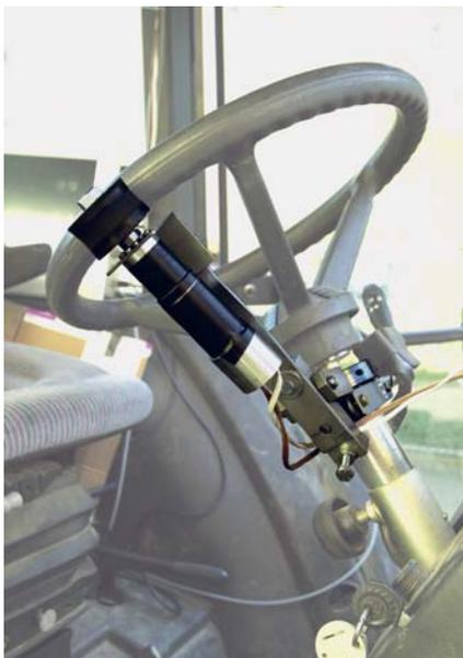
Abb. 9: Lenkeingriff am Lenkrad: oben Trimble EZ-Steer, Mitte John-Deere Auto-Trac Universal, unten Prototyp von Agro-scope Reckenholz-Tänikon ART.
