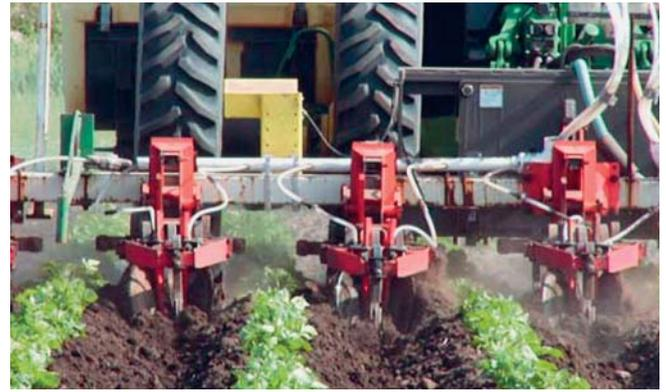
Abb. 6: Parallelfahrssysteme ohne GPS: links Ultraschalltaster von Reichardt-Steuerungstechnik zur Erkennung von Fahrgassen, rechts Eco-Dan-Kamera zur Lenkung des Hackgeräts zwischen den Reihen.
