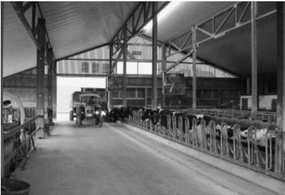
Abb. 9: Aussenklimastall D1. Die Fertighalle hat eine Dachstruktur mit Längsbindern und selbsttragender Trapezblecheindeckung. Der First ist offen (60 cm) und trennt das Satteldach über der ganzen Länge in zwei Pultdächer.
