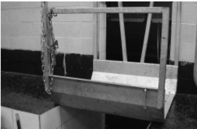
Abb. 16: Die Melkstandgrube ist mit dem Milchzimmer ebenerdig. Die Kühe überqueren die Melkstandgrube mittels einer wegdrehbaren Passerelle (Betrieb F1).
