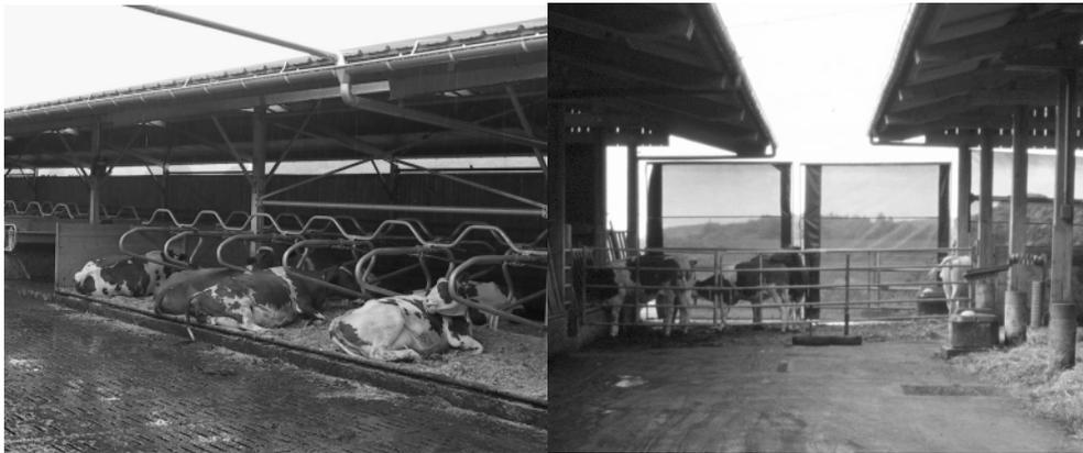
Abbildung 13: Offenes Stallgebäude mit isoliertem Dach reduziert die Temperatur im Stall, eine Abtrennung mit Windschutznetz mindert die Luftgeschwindigkeit im Laufhof (Fotos: Zähler, Agroscope FAT Tänikon, 2004, 1999).
