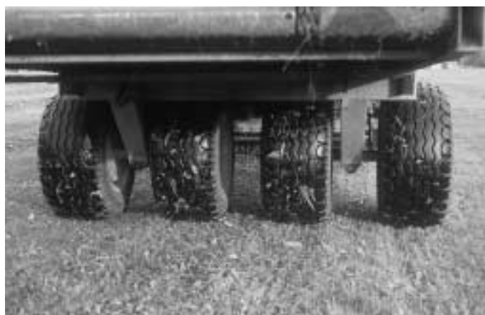
Abb. 2: Die Doppelpendelachse (linkes Bild) ist für Graswirtschaftsbetriebe mit täglichem Eingrasen die tauglichste Lösung, da sie den Boden und die Grasnarbe optimal schont. Weniger ideal, dafür kostengünstiger ist die versetzte Doppelachse (rechtes Bild).
