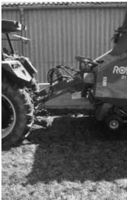
Abb. 12: Für die Flachsilosbeschickung mit dem Erntewagen muss dieser eine hydraulische Knickdeichsel haben, damit sich der Flachsilo problemlos befahren lässt.
