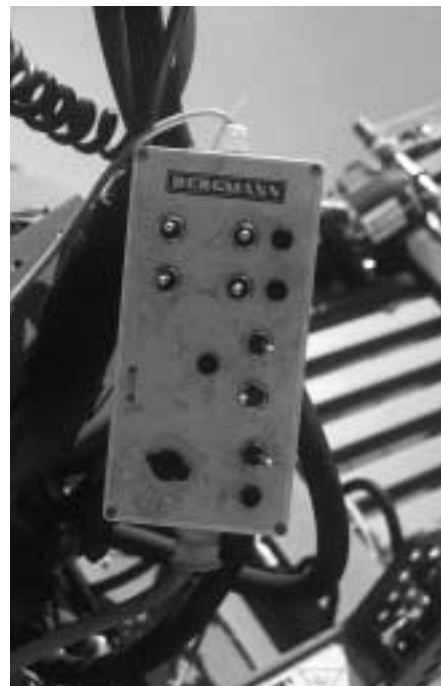
Abb. 13: Die elektrohydraulische Komfortsteuerung ermöglicht es, sämtliche Arbeitsfunktionen vom Traktorsitz aus bequem und sicher anzusteuern.
