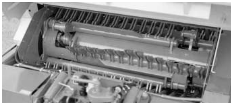
Abb. 7: Seitlich versetzt angeordnete Förderer sollen im Vergleich zu durchgehenden Schwingen geringere Kraftspitzen und somit ein gleichmäßiges Laden ermöglichen (Quelle: Krone).
