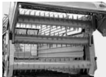
Abb. 11: Dosierladewagen mit drei Dosierwalzen vergrössern das nutzbare Ladevolumen. Zudem laden sie gleichmässiger ab, was besonders beim Entladen von Dürrfutter von Vorteil ist (Quelle: Deutz-Fahr).
