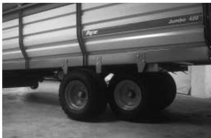
Abb. 2: Die Doppelpendelachse (linkes Bild) ist für Graswirtschaftsbetriebe mit täglichem Eingrasen die tauglichste Lösung, da sie den Boden und die Grasnarbe optimal schont. Weniger ideal, dafür kostengünstiger ist die versetzte Doppelachse (rechtes Bild).
