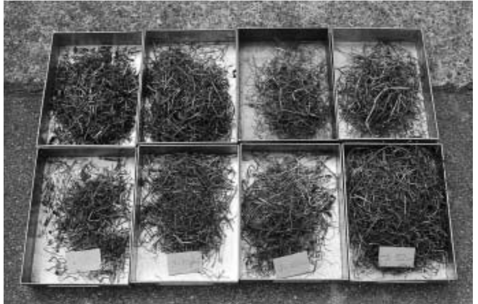
Abb. 17: Auslesen des Halmgutes zur Analyse der Schnittlänge von Schneidwerken bei Ladewagen. Beim Laderotor (obere Schalenreihe) ist die Schnittqualität sichtbar besser als beim Schwingenförderer (untere Schalenreihe).
